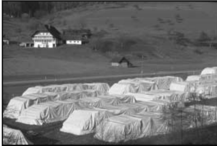
Foto 14: Rundholzlagerung durch O 2 -Entzug in Deutschland (Quelle: FVA)
