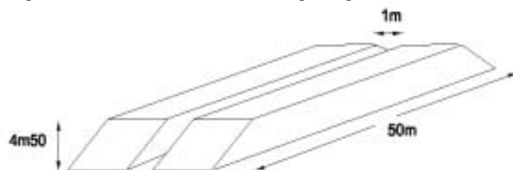
Abbildung 7: Grundanordnung für Lagerung (Quelle: AFOCEL)
